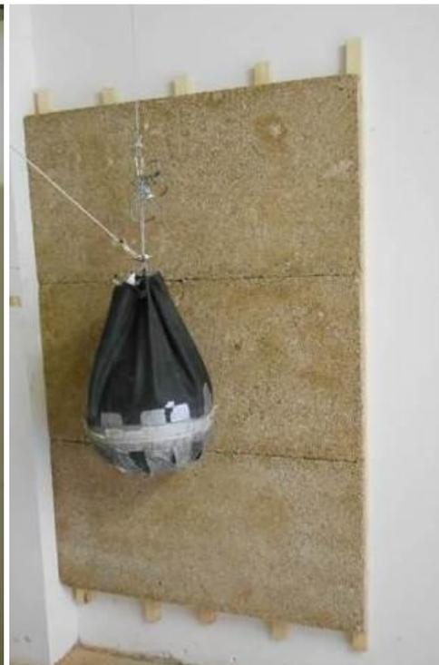
**3- Dettagli di prova: Pannelli fissati a muro con listelli di interasse 30 cm**
