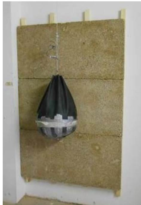
**4- Dettagli di prova: Pannelli fissati a muro con listelli di interasse 40 cm**
