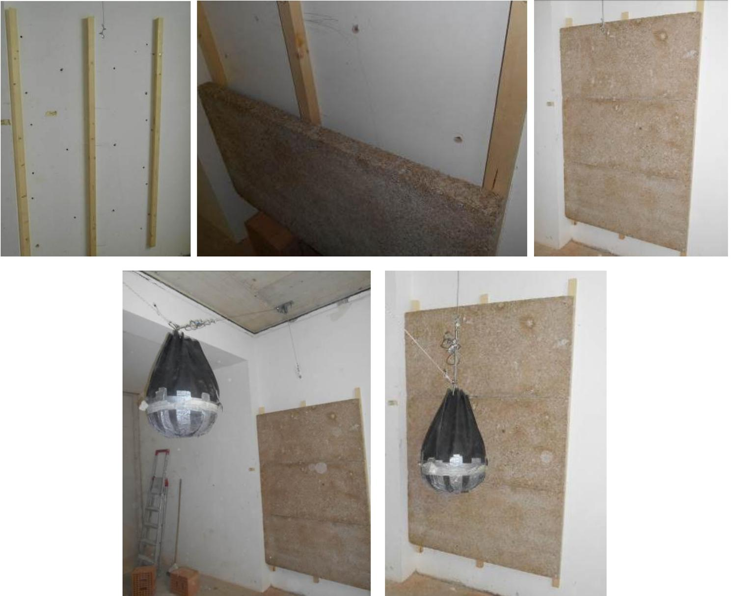
**5- Dettagli di prova: Pannelli fissati a muro con listelli di interasse 60 cm**
