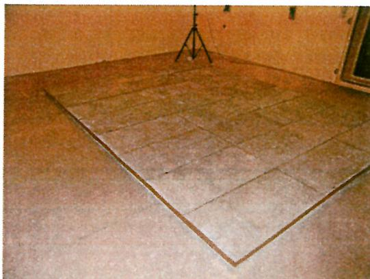
**Descrizione del campione in prova:** pannelli mod. "Lastra Focus", dimensione 50 cm x 100 cm composti da calcestruzzo (spessore 5 cm, densità 2370 kg/m<sup>3</sup>) e argilla espansa (spessore 2 cm, densità 580 kg/m<sup>3</sup>). Riempimento tra i pannelli effettuato mediante sigillante siliconico.
