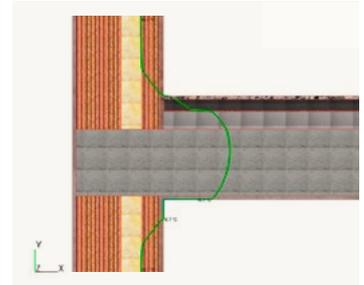
Da notare la presenza di una considerevole lunghezza di condensazione lungo la superficie all'intradosso. L'impiego di Esse Board risulta indispensabile per il rispetto dei limiti normativi in relazione all'insorgenza di muffe.
