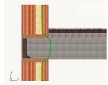
Al fine di raccordare gli strati di isolamento è opportuno inserire all'intradosso e all'estradosso del cordolo un pannello in XILITE; in questo modo l'isoterma di condensazione rimane interna alla sezione, la verifica è soddisfatta.
