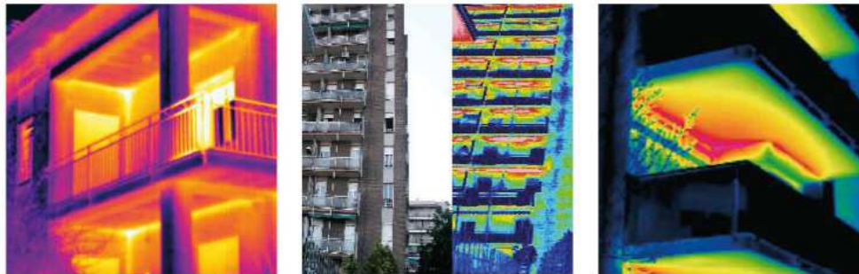
Termografie di Ponti Termici non corretti dove non è presente ESSE THERM®
