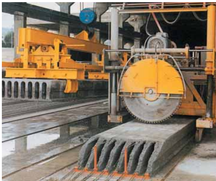
Fig. 2.5 Taglio delle lastre e loro prelievo dal banco di getto
