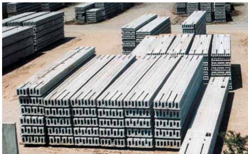
Fig. 2.6 Piazzale di stoccaggio di solai alveolari
