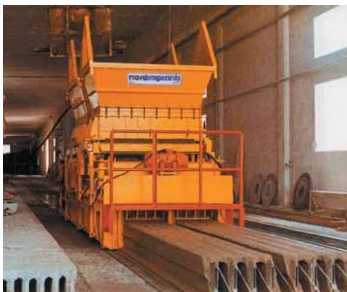
Fig. 2.4 Getto in continuo del calcestruzzo
