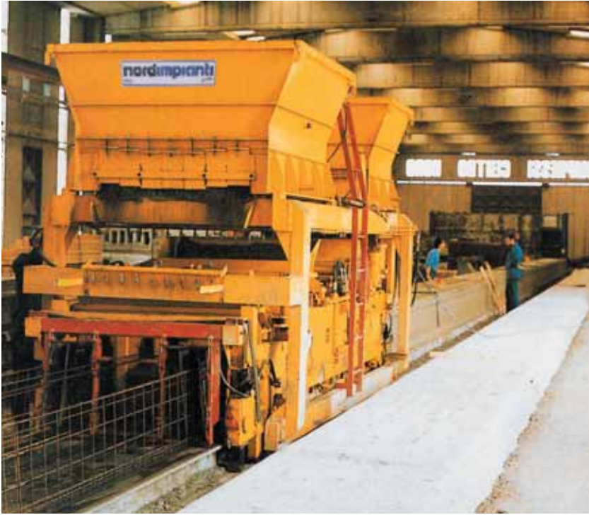
Fig. 2.1 Macchina vibrofinitrice (procedimento "slipform")
