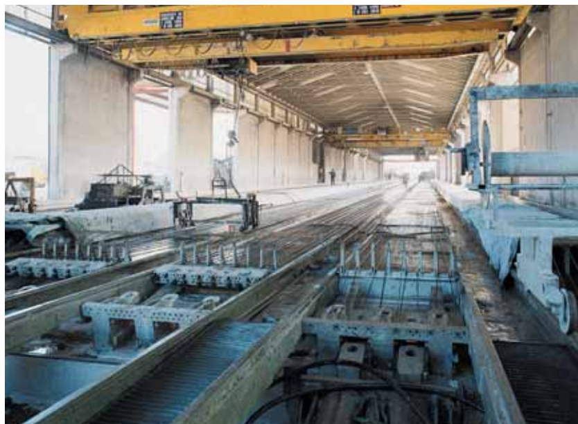
Fig. 2.3 L'armatura di precompressione tesata sul banco di getto
