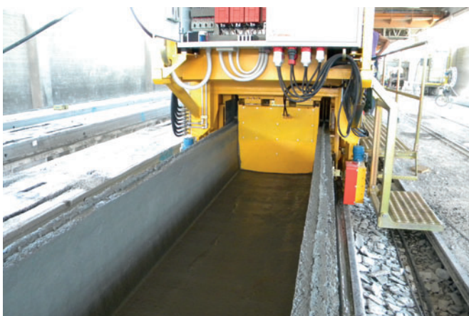
Macchina Vibrofinitrice Nordimpianti per la produzione di elementi prefabbricati ad uso infrastrutturale con sezione ad U alta fino ad 1 metro.
