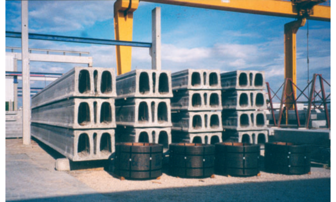
Pannello alveolare con altezza della sezione trasversale pari a 1000 mm nell'area di stoccaggio
