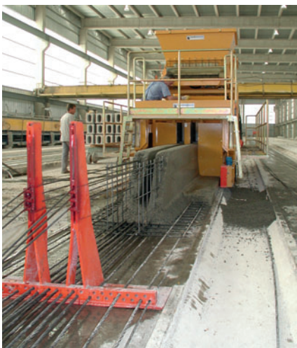
Innesto formatore installato su macchina Vibrofinitrice Nordimpianti per solai a doppio T rovescio: tale sezione fornisce una grande flessibilità di utilizzo.
