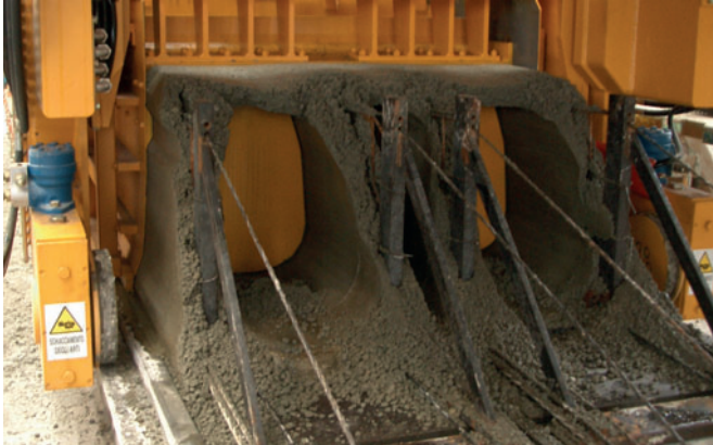
Innesto formatore montato su macchina Vibrofinitrice Nordimpianti realizzato specificatamente per produrre il solaio alveolare con 3 fori notevolmente alleggerito.
