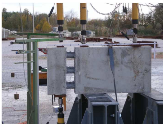
Foto di allestimento di una prova a taglio sul piano della connessione.
