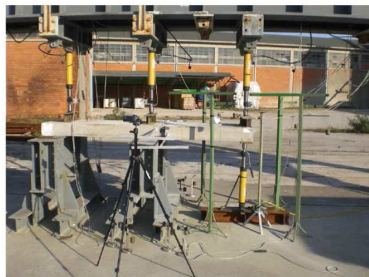
Foto dell'allestimento di una prova a flessione ciclica.
