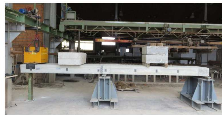
Allestimento di una prova a fatica.
