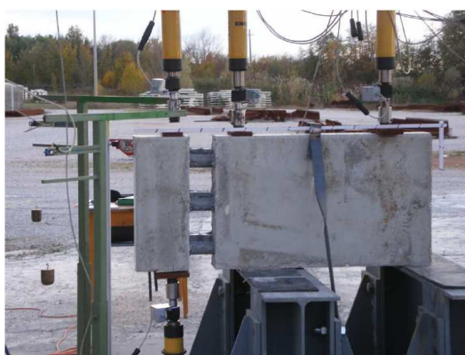
Foto di allestimento di una prova a taglio sul piano della connessione.
